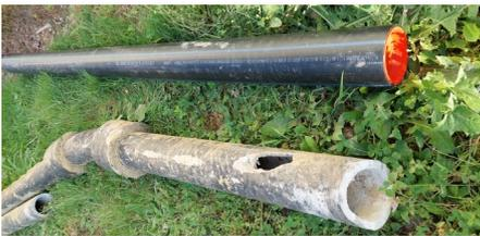
*Auf der linken Seite ersichtlich ein altes AZ-Rohr aus der bereits anfälligen Leitung aus den 50iger-Jahren, rechts daneben ein Stück des neu verwendeten Rohrsystems.*
